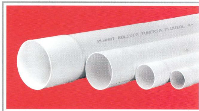
La tubería de desagüe e instalación eléctrica PLAMAT debe ser almacenada en lugares cubiertos o bajo sombra. Las campanas deben quedar libres y se debe cuidar no formar pilas de más de un metro de altura sobre superficies lisas.
